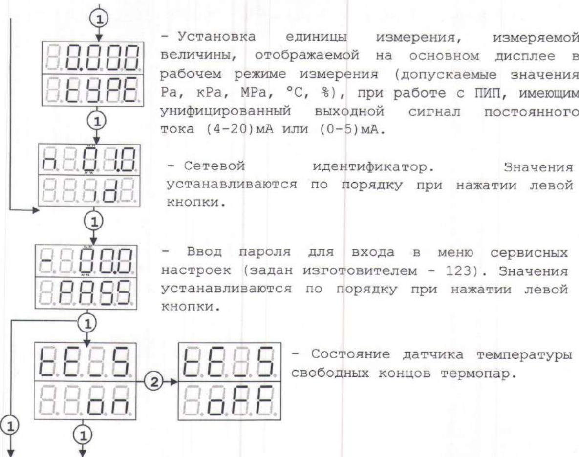
Далее необходимо поочередно нажимать левую кнопку измерителя для выхода из режима программирования в режим отображения текущего времени; либо до появления меню юстировки для юстировки измерителя:
