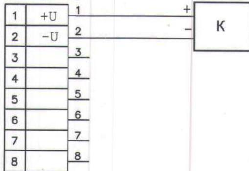
КН - компаратор напряжения Р-3003;
